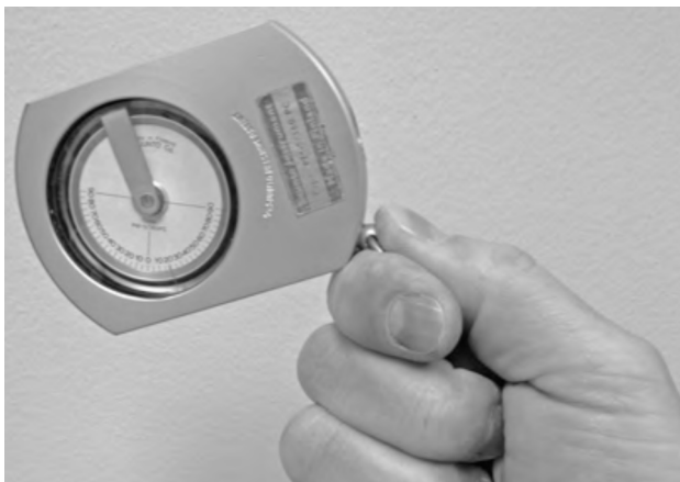
Figure 1. Suunto PM-5 analogue forestry clinometer.
