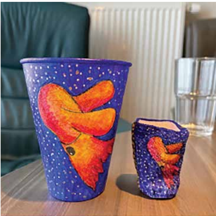
海底有很大的压力！发泡胶杯在正常尺寸和在4400米深度压缩后的比较（图片：AKMA项目）
