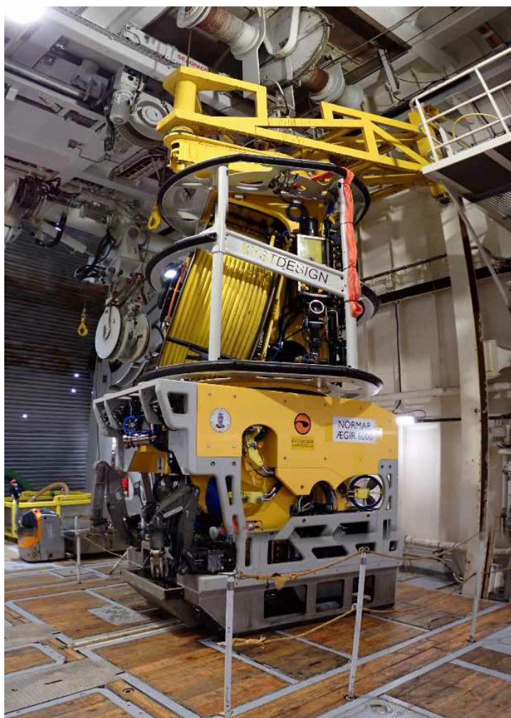
ÆGIR 6000 - це дистанційно керований апарат (ROV), призначений для вивчення морського дна вченими. Він працює на глибинах до 6000 метрів. ÆGIR знаходиться в Норвезькій морській робототехнічній лабораторії університету Бергена (UiB). Фото: Solmaz Mohadjer.
