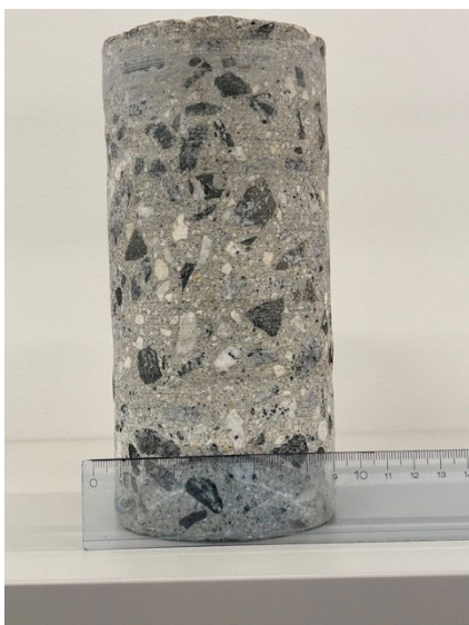
Til venstre: Kjerneprøve av gulvet/taket mellom 1 og 2 etasje i Naturfagbygget tatt på forfatterens kontor. Til høyre: Den oransje fargen som dekket neste alle rom på Gjennomgangsbygget i 1974, her dukket opp bak en gammel kontakt. (Foto: Morten Hald).
