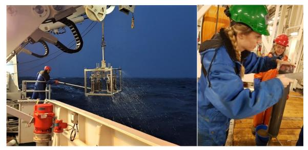
Multicorer som dukker opp fra havets dyp med sedimentkjerner (venstre) og snitting av sedimentkjerne (høyre).
