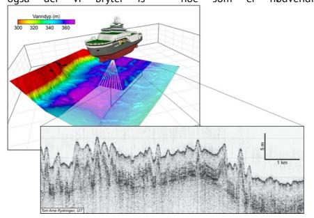
Figur 1. Multistrålekkoloddet til FF «Kronprins Haakon» gir et tredimensjonalt bilde av havbunnen, mens penetrasjonsekkoloddet gir et snitt gjennom avleiringene i undergrunnen.
