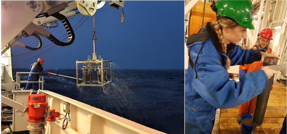
Multicorer som dukker opp fra havets dyp med sedimentkjerner (venstre) og snitting av sedimentkjerne (høyre).
