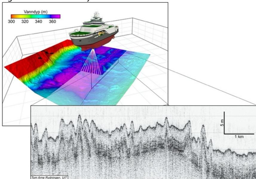
Figur 1. Multistråleekkoloddet til FF «Kronprins Haakon» gir et tredimensjonalt bilde av havbunnen, mens penetrasjonsekkoloddet gir et snitt gjennom avleiringene i undergrunnen.
