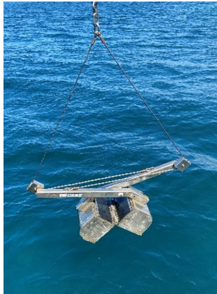
Seisma på feltarbeid i Repparfjorden (til venstre). Van Veen-grabb som ble benyttet til prøvetaking av sediment og bunndyr (til høyre).
