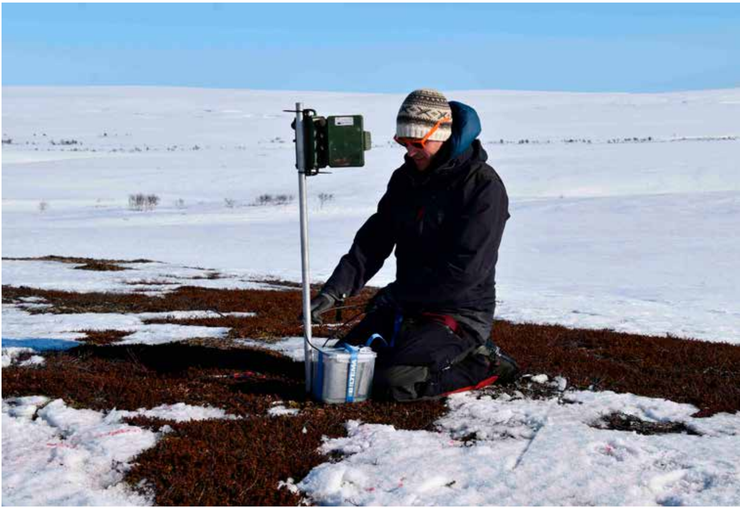
Figur 5. Installasjon av en lytteboks på Varangerhalvøya. Foto: Jan Erik Knutsen
