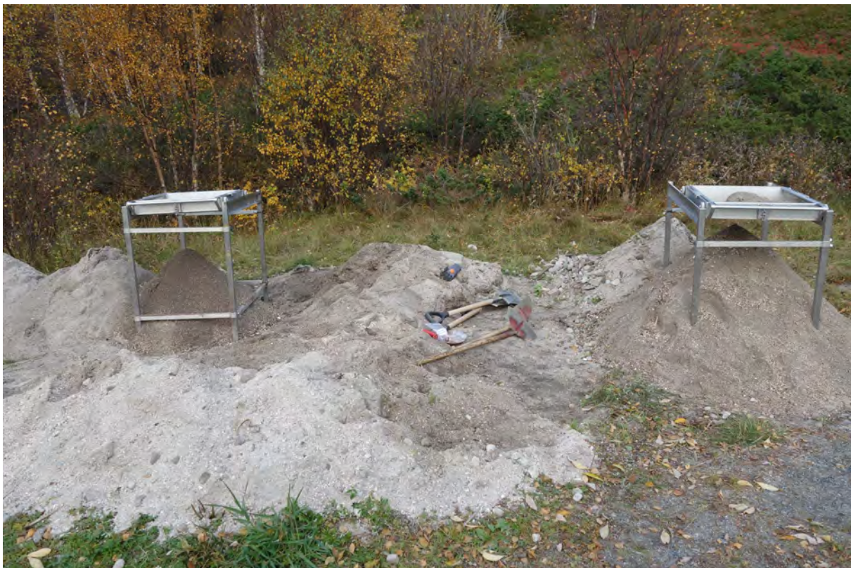
Figur 3 - Tørrsilding av løsmassene
