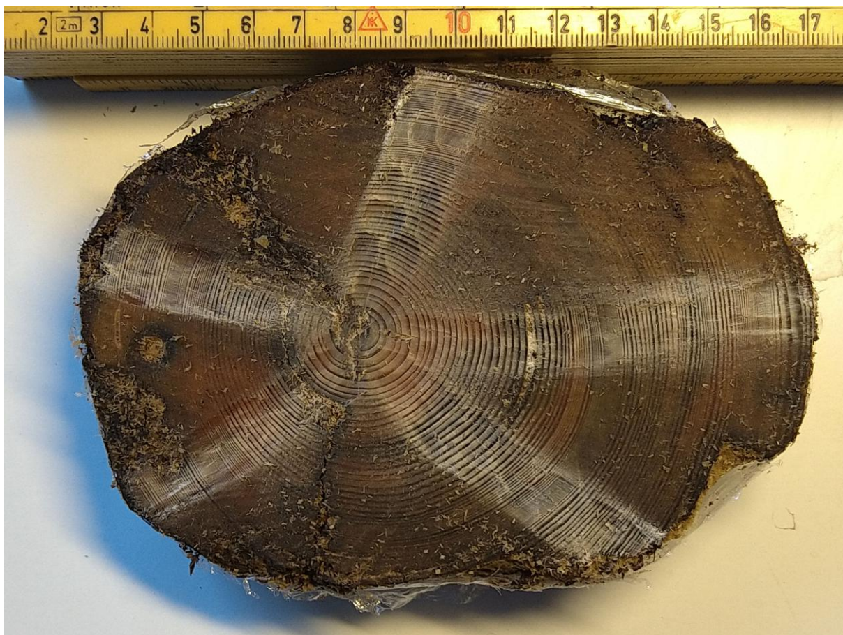
Figur 4: Tverrsnitt av bjelke 937 med fem preparerte radier (BOE001A-E).
