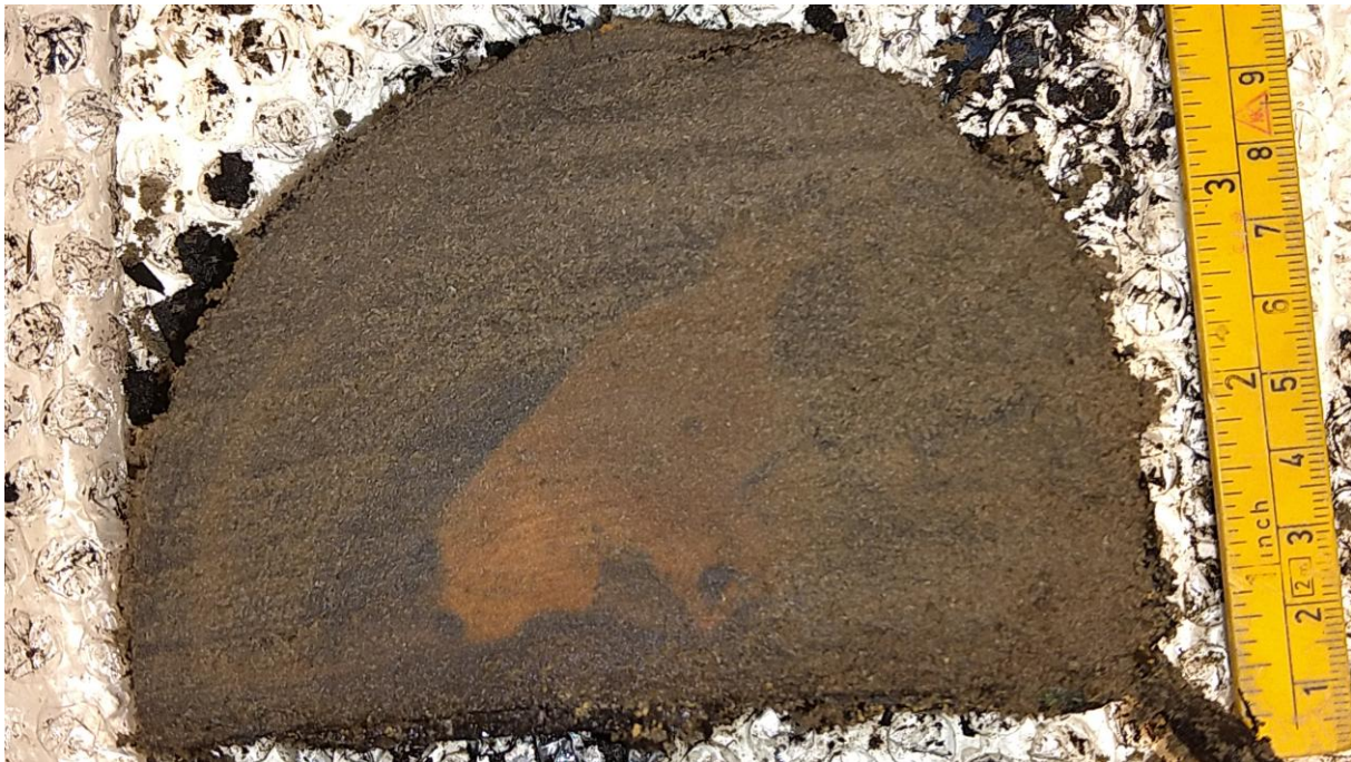
Figur 6: Skive av stolpe 387. Stolpen er en halvkløving og av nokså myk konsistens.
