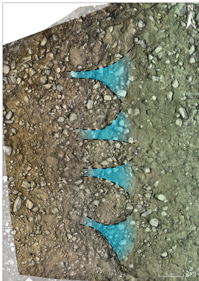
Figur 22 Spår av ras på grund av vatten.
