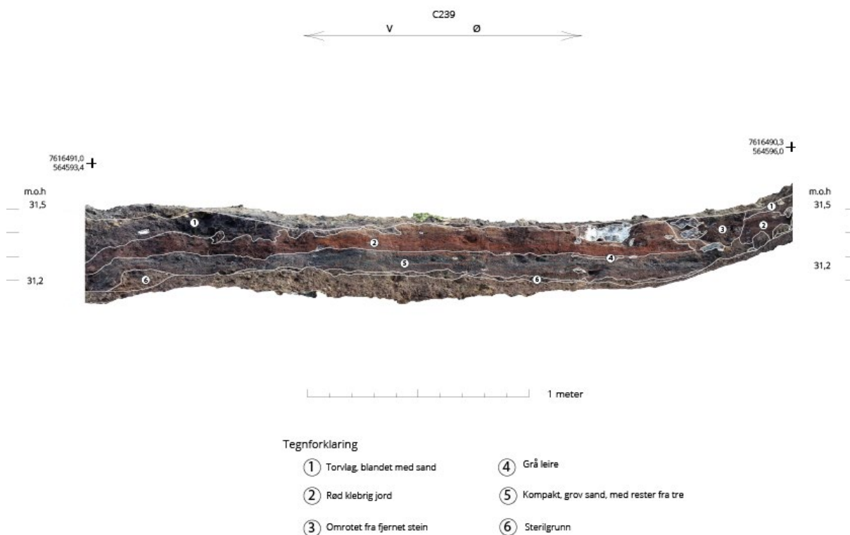
Figur 9: Profiltegning av C239.
